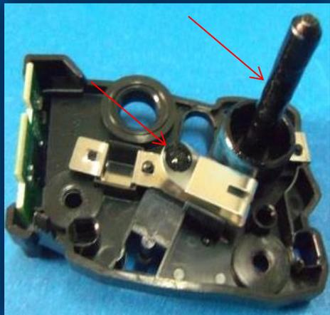
Preserve a graxa condutiva existente na lateral de contato elétrico do cilindro.
